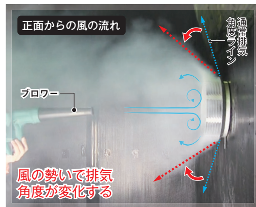
前方からの風の勢いで、排気角度が変化し、更に汚れを軽減
